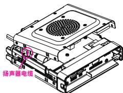
6. 拆下顶盖前，先从主机内板的插头上拔下从顶盖延伸出来的扬声器电缆。
