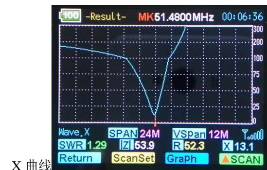
b、旋转编码器移动光标，查看扫描曲线上每个扫描频点上的的具体测量结果参数。
